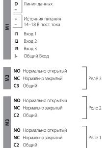
Реле замыкают сухие контакты, характеристики: макс 250 В~10 А резистивной нагрузки и 2 А индуктивной нагрузки.
