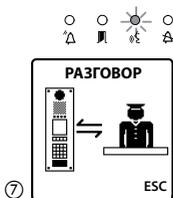
Надпись “РАЗГОВОР” и специальный символ на экране (рис. 7), а также включение светодиода указывают на то, что консьерж принял вызов.
