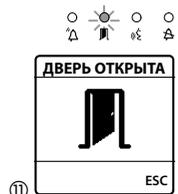
Если ответивший абонент откроет замок двери, то появится надпись “ДВЕРЬ ОТКРЫТА” (рис. ⑪) и включится светодиод (). Также может прозвучать голосовое сообщение: “Пожалуйста, проходите”, если система настроена соответствующим образом.
